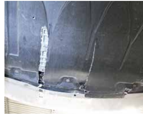
Beschädigung der Unterbodenverkleidung
