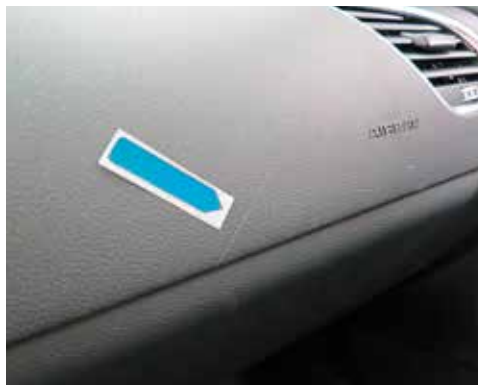
Geringfügige Beschädigung der Kunststoffverkleidung
