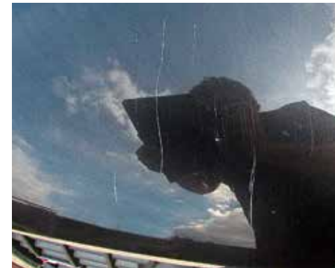
Beschädigung des Basislacks
