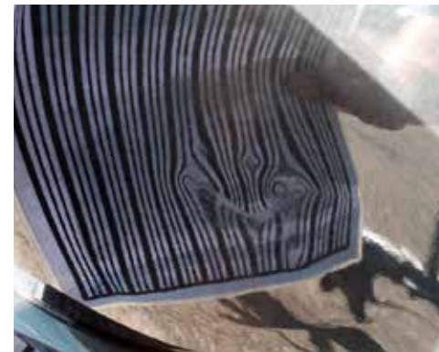
Drei Dellen an einem Karosserieteil
