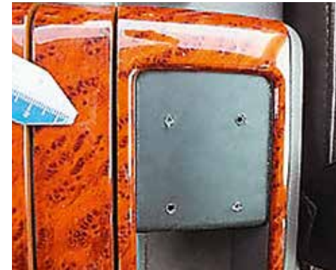
Bohrlöcher im Verkleidungsteil
